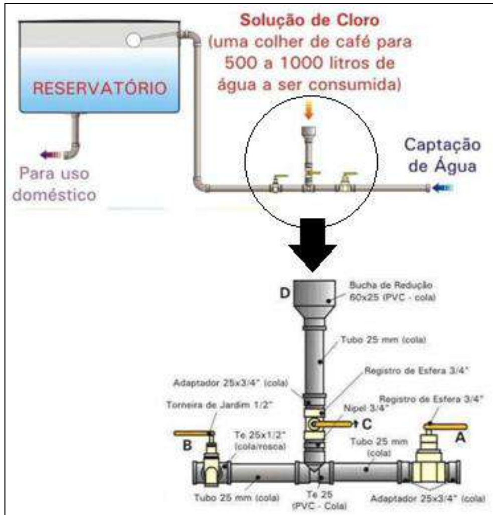
Figura 17 - Esquema do sistema de cloração desenvolvido pela Embrapa
